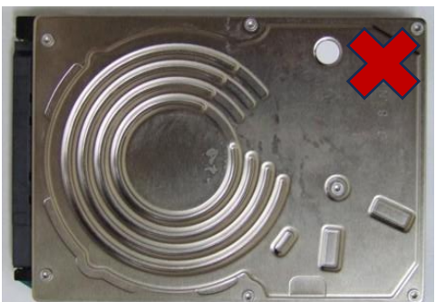
(3) 金屬外殼凹陷 (Covering dent)
